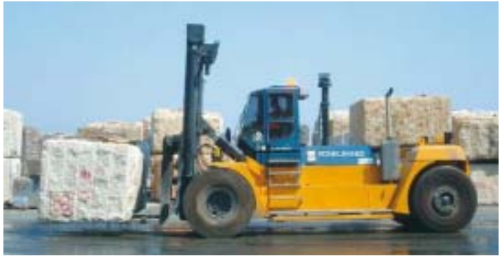
Schwer wie ein Felsen. Große Steinblöcke haben ein hohes dynamisches Gewicht, das nur von leistungsfähigen Staplern beherrscht wird (25-45 Tonnen).
