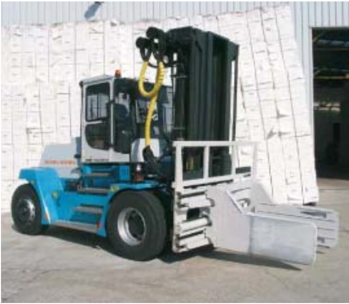
Integrierte Ballenklammer für Papier und Zellstoff (10 bis 13,6 Tonnen).
