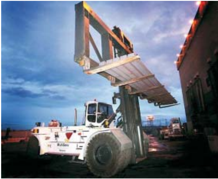
Schwere Stapler für schweres Material. Für das Anheben von Stahlplatten und Coils werden große Fahrzeuge benötigt (bis zu 60 Tonnen).
