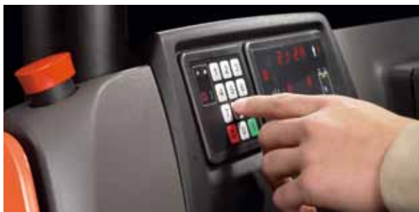
Die BT Reflex N-Serie verfügt standardmäßig über eine PIN-Code-Aktivierung, um sicherzustellen, dass die Stapler ausschließlich von autorisierten Fahrern genutzt werden
