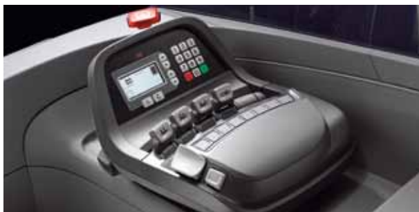
Die serienmäßigen Tipptasten ermöglichen die Steuerung der Gabelbewegung mit den Fingerspitzen
