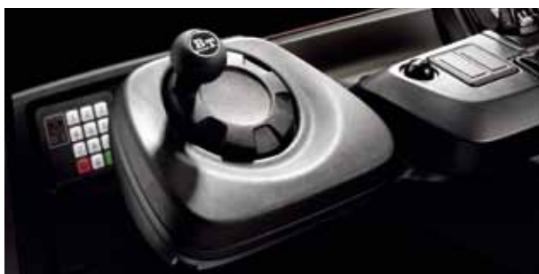
Die elektronische, progressive 360°-Lenkung der BT Reflex N-Serie trägt entscheidend zur außergewöhnlichen Fahrdynamik bei
