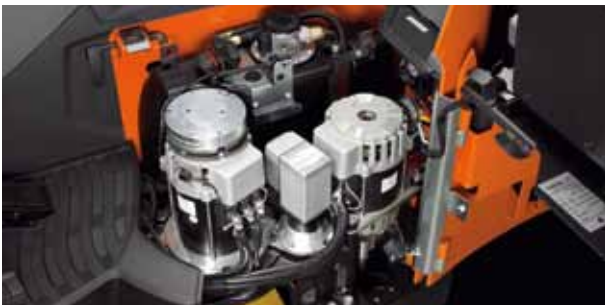
Versiegelte Elektronikseinheiten, Motoren ohne Kohlebürsten und leckagefreie Verbindungen sorgen für die hohe Zuverlässigkeit der BT Reflex R-/E-Serie
