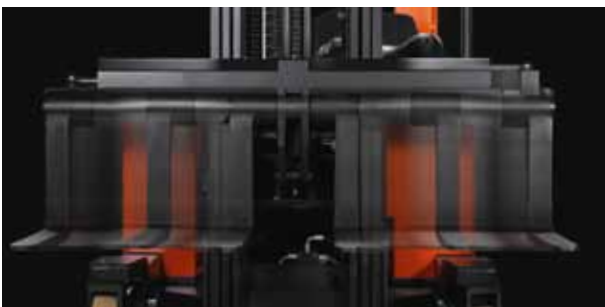
Das Maß über den Gabeln kann bei der BT Reflex F-Serie von 0,54 – 2,22 m variiert werden
