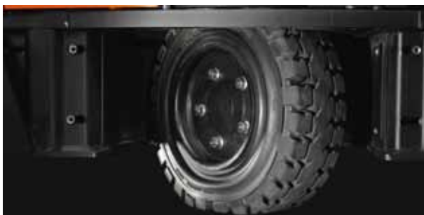
Alle drei Räder des RRE160R sind wie bei Frontstaplern ausgelegt – optimiert für den Einsatz im Freien, aber auch für den Inneneinsatz gut geeignet
